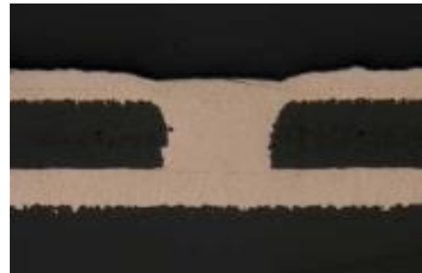
基板Via部分フィリング後
