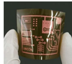
ポリイミド基板上に導電性銅ナノインクを用いて形成した回路
