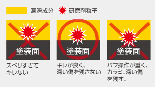
図2 研磨粒子のコントロール
